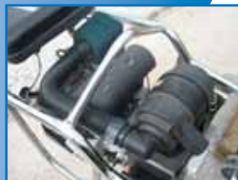
RT 66/RT 74 Honda GX 120 s voliteľnou možnosťou dvojitého filtra vzduchu.
